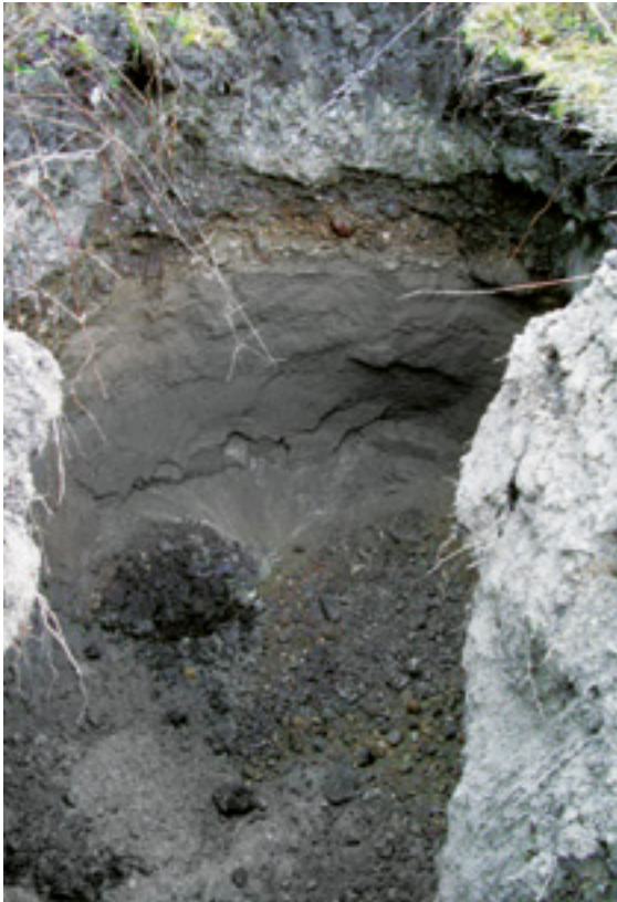
10 Baggerschlitz für die geologischen Untersuchungen der Baugrube; Foto Henauer Gugler AG
